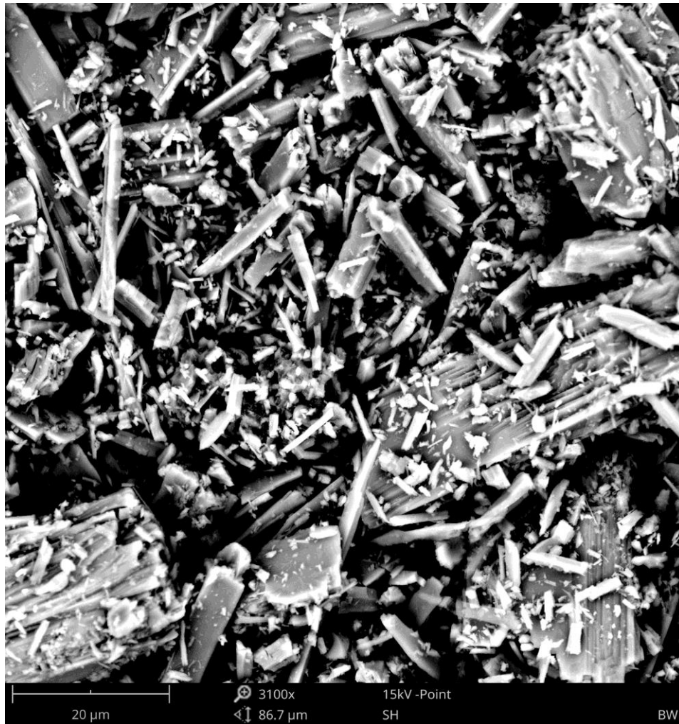
Figura 8. Micrografía de microscopio electrónico de barrido de la wollastonita, \text{CaSiO}_3 mostrando su forma acicular característica.
