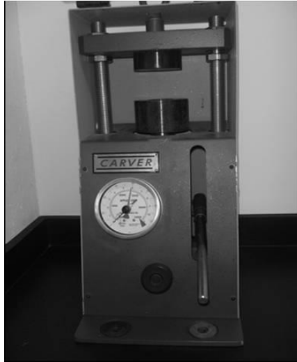
Figura 20. Prensa hidráulica utilizada para la fabricación de pastillas.
