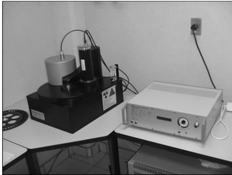
Figura 22. Equipo marca RISØ TL-OSL modelo TL-DA-20 utilizado para llevar a cabo las mediciones de termoluminiscencia.
