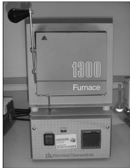
Figura 21. Horno utilizado para los tratamientos térmicos.
