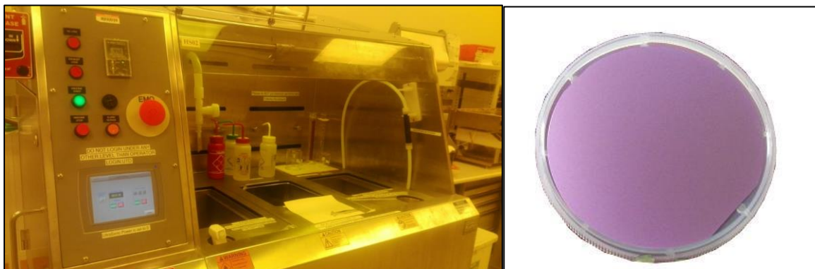
Figura 24. a) Campana de solventes general Leatherwood Plastics, Inc., Instalaciones del NSERL, UTDallas.; b) Wafers Prime Si+SiO 2 utilizados para el depósito.
