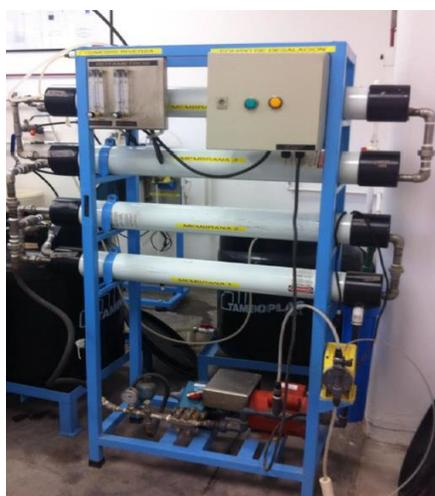
**Ilustración 3.** Planta de OI instalada en ITSON, Obregón, Sonora, utilizando las membranas comerciales de la empresa Nitto Denko de Hydranautics, modelo SWC4 MAX de 8"x40" [51].
