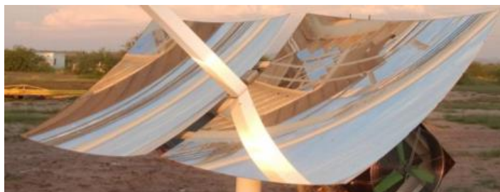
Figura 33. Disco parabólico utilizado en el sistema de seguimiento 2M (Cisneros-Cárdenas, 2018)
