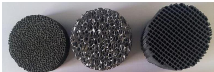
Figura 1. Receptores volumétricos porosos y multicanal (derecha) de SiC y compuestos a base de SiC (Mey-Cloutier, Caliot, Kribus, Gray, & Flamant, 2016).
