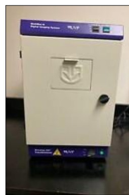
Figura 14. Cámara de rayos UV (UVP MultiDoc-It Digital Imaging System).
