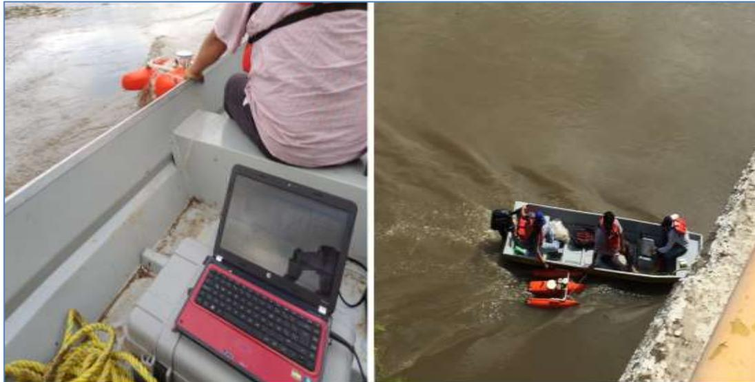
Figura 9.9. Recolección de la información en una computadora portátil y recorrido con el ADCP.
