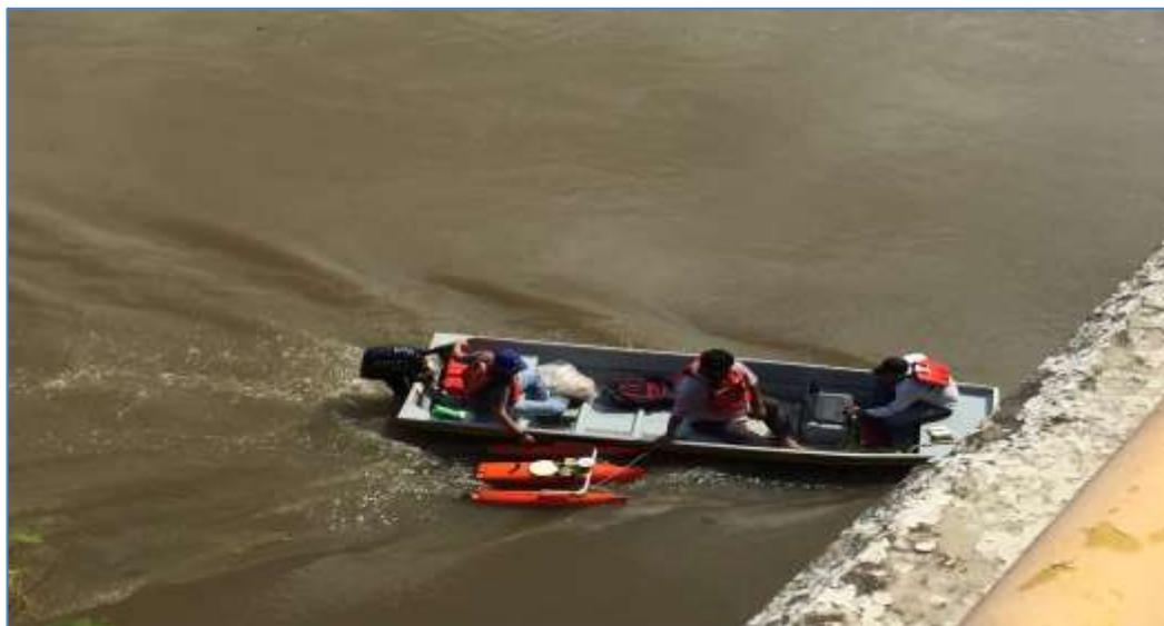
Figura 9.7. Uso del Perfilador acústico Doppler River ray.
