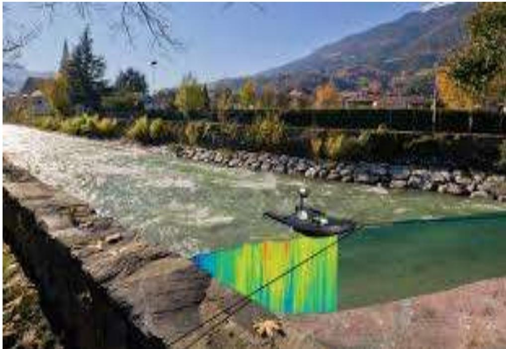
Figura 9.3. Perfilador acústico Doppler
