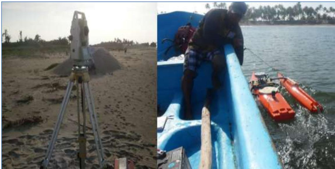
Figura 7.2. Levantamiento de geometrías complejas, con equipo estación total (Leica Ts06 Plus) y ADCP (Riverray).
