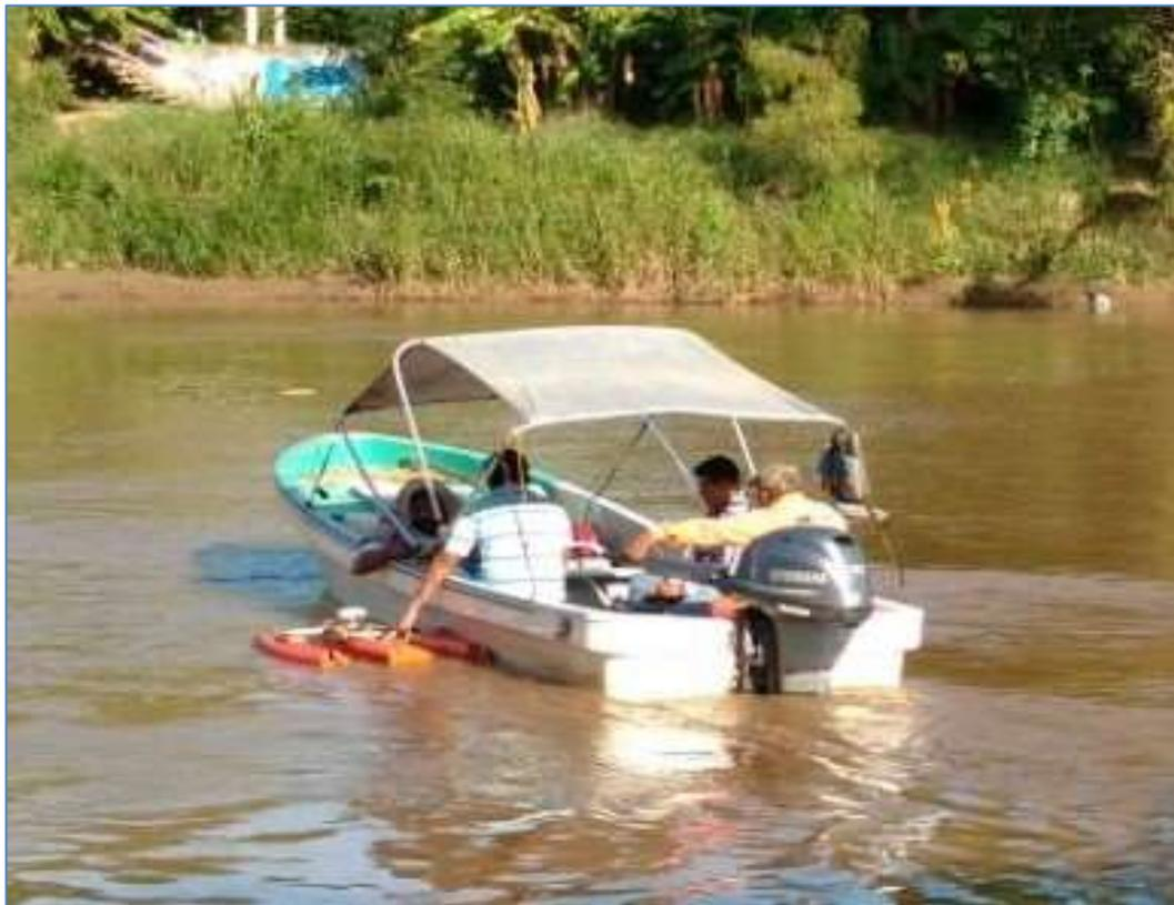
**Figura 6.4. Perfilador acústico Doppler River ray.**
