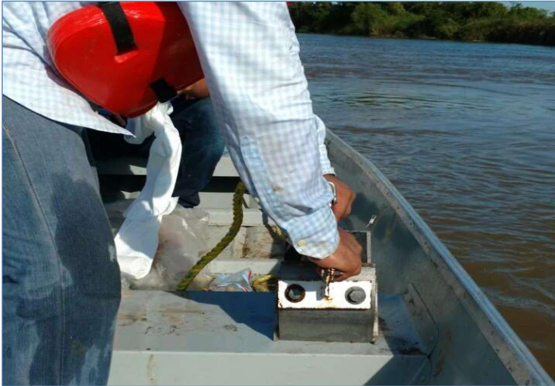
**Figura 9.10. Muestreo con draga de material de fondo río Carrizal.**
