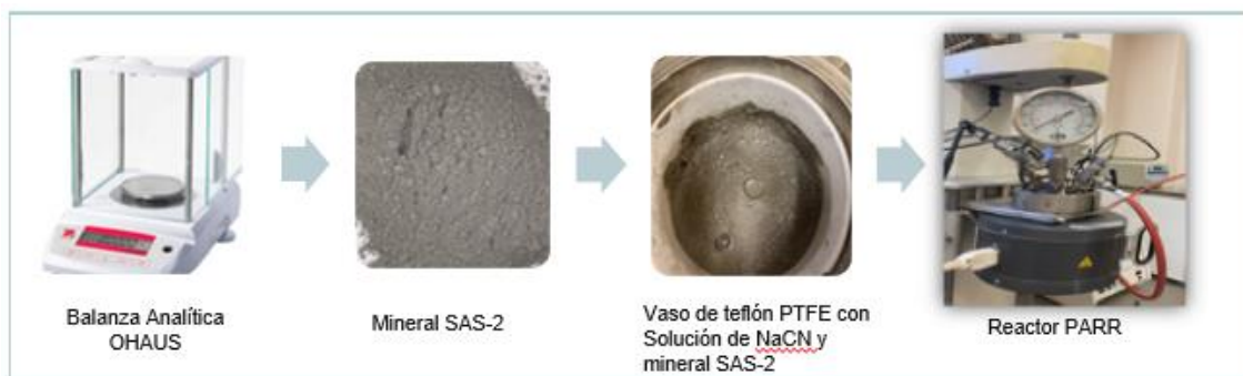
Figura 6. Proceso para la lixiviación oxidativa alcalina de la muestra SAS-2
