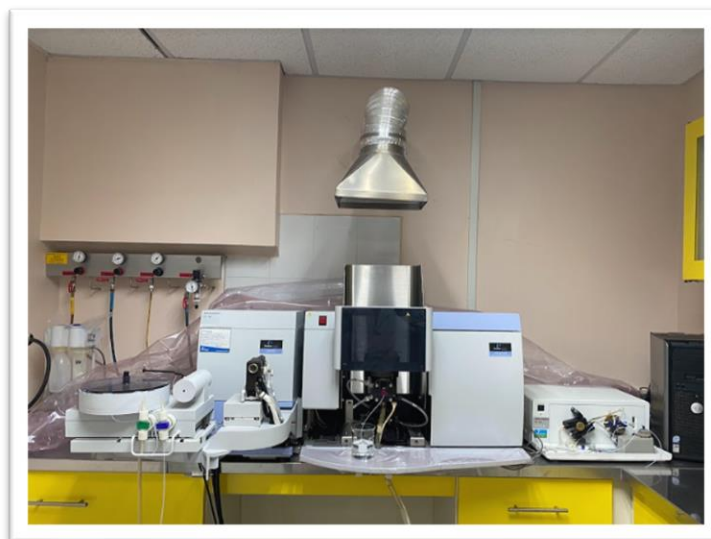
Figura 7. Equipo de Absorción Atómica Perkin Elmer AAnalyst 400
