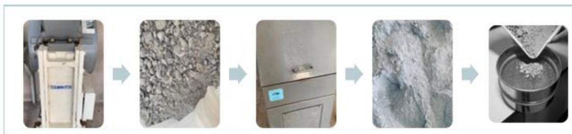
Figura 3. Proceso para la reducción de tamaño de la muestra SAS-2
