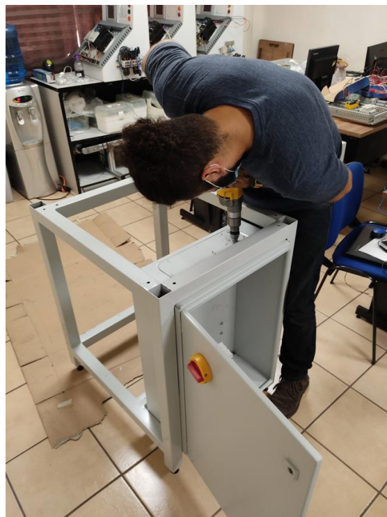
Imagen 8.3.3 Montaje de gabinete en estructura y barrenación para glándulas. {1}
