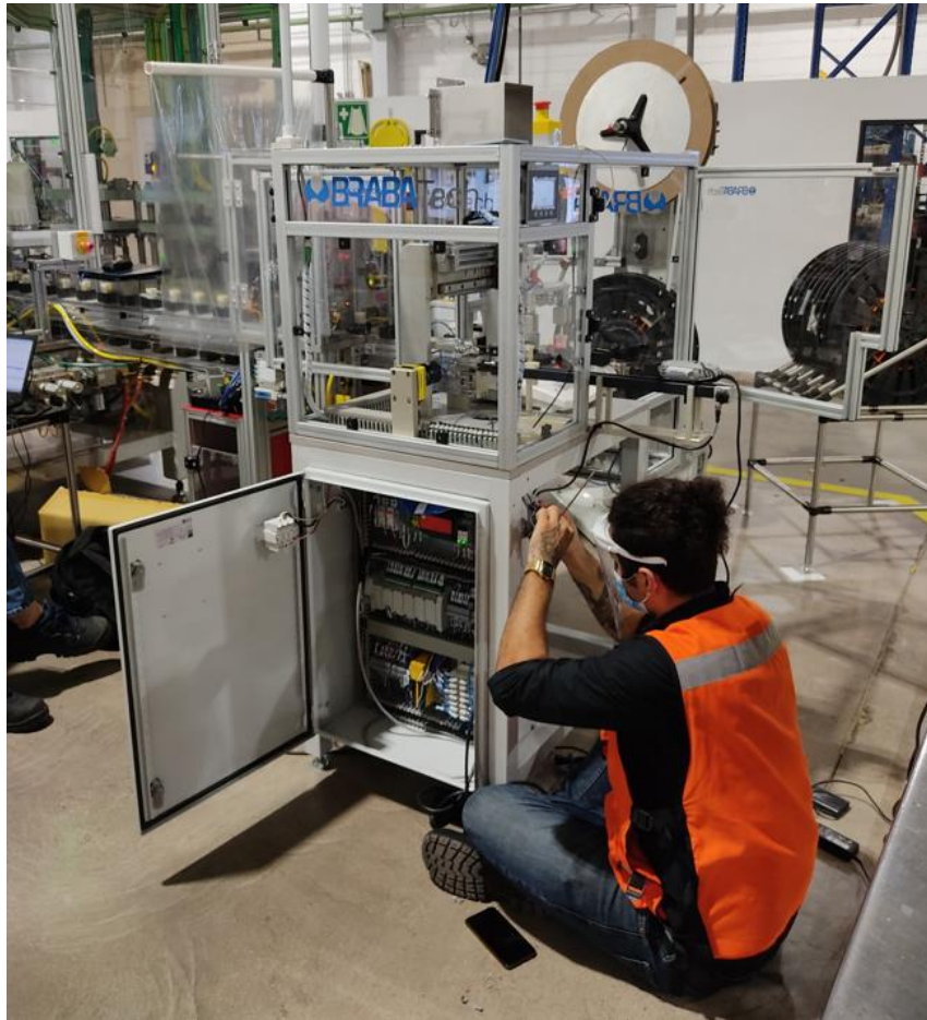
Imagen 8.5.1 Cableado de señales con el otro equipo. {1}
