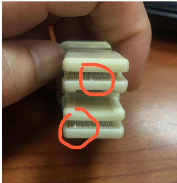
Imagen 5.4. Inner Housing con imperfecciones en la posición de las terminales. {1}
