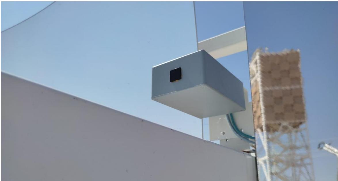
*Figura 21. Cámara de visión artificial*
