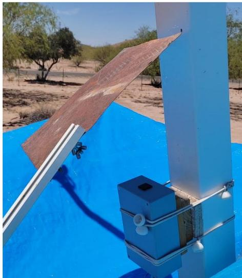
**Figura 57.** Obstrucción de cámara, simulación paso de nubes
