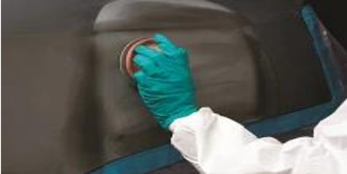
Figura 8.4 Lijado de imperfecciones del primer
