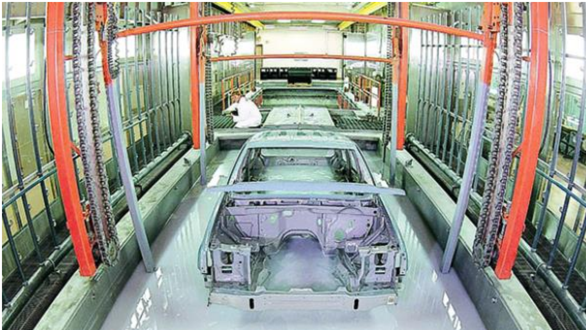
Figura 8.1 Unidad sumergida en las cubas de e-coat
