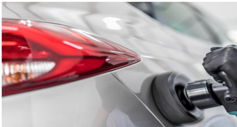
Figura 8.7 Pulido de imperfecciones de la capa de clear coat
