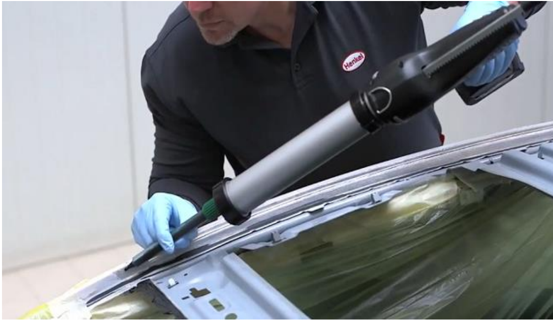
Figura 8.2 Aplicación de en área de quemacocos
