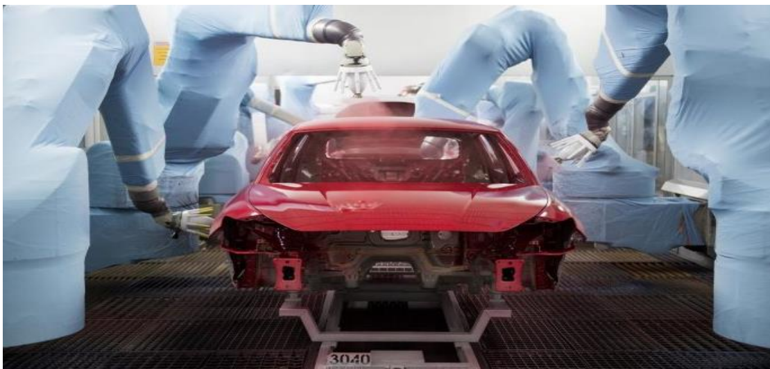
Figura 8.5 Aplicación de la capa de esmalte
