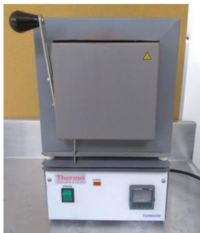
Figura 30) Horno de laboratorio utilizado para el crecimiento controlado de SiO 2 .
