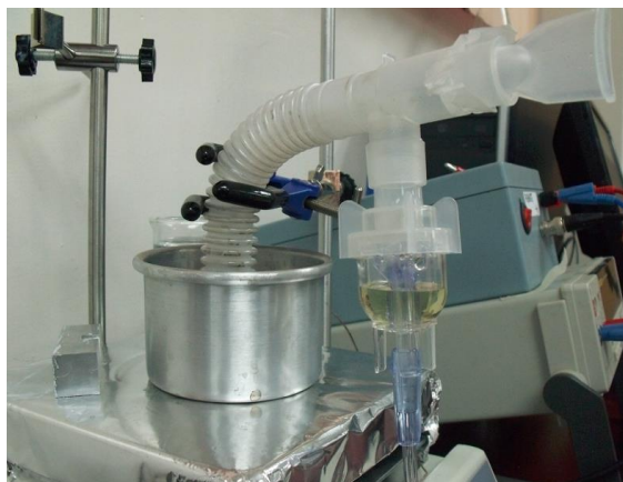
Figura 36) Sistema de microaspersión con AgNPs.
