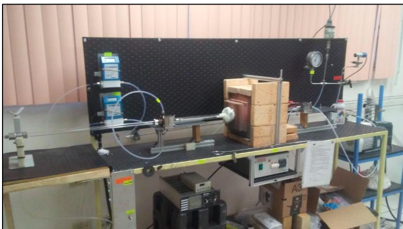
Figura 32) Sistema CVD para la síntesis de películas de ZnO.
