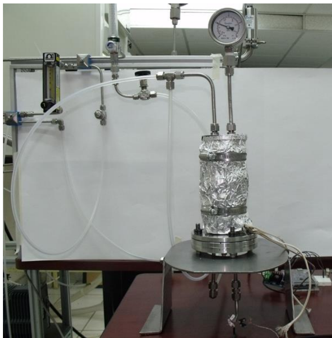
Figura 45) Sistema de control de gases.
