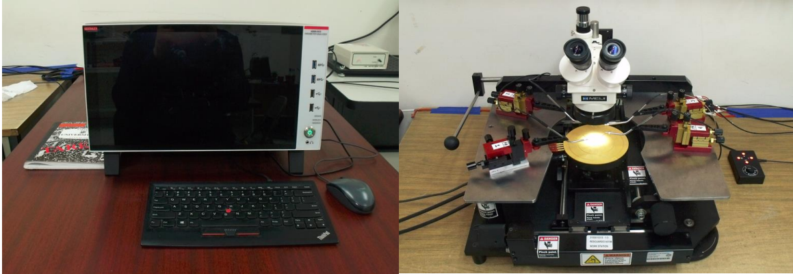
Figura 69) Equipo de caracterización eléctrica Keithley 4200 (izq), estación de trabajo con micro manipuladores y microscopio óptico (drch).
