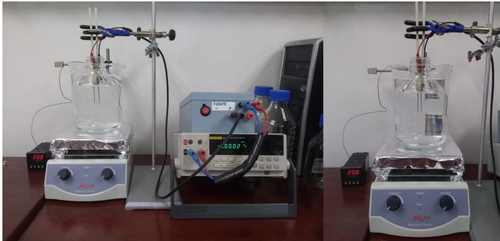
Figura 29) Sistema de electrolisis automatizado (izquierda), baño maría (derecha).
