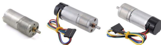
Figura 4.1: Motor pololu relación 34:1.
