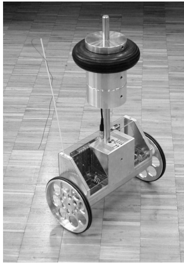
Figura 1.2: Péndulo invertido JOE [4].
