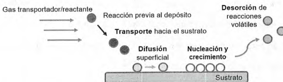
Figura 2.8 Etapas del proceso de depósito por vapor químico.
