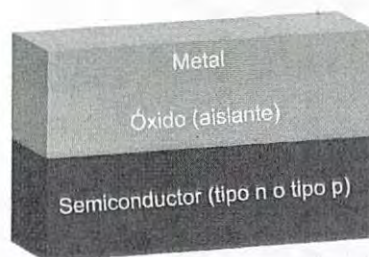
Figura 2.3 Esquema de un capacitor MOS.
