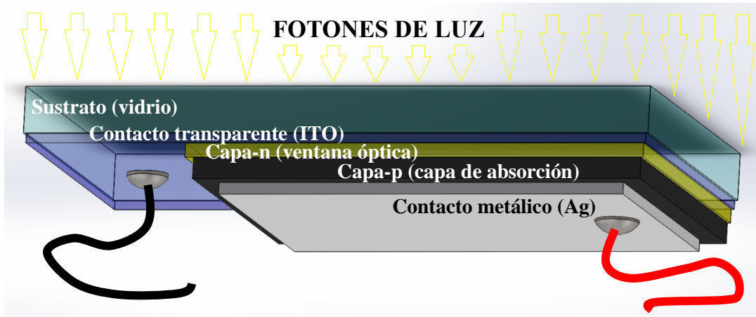
Figura 9. Estructura de la Celda solar, vidrio/ITO/CdS/PbS/Ag.
