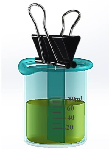
Figura 17. Acomodo del sustrato durante el depósito de las películas semiconductoras.
