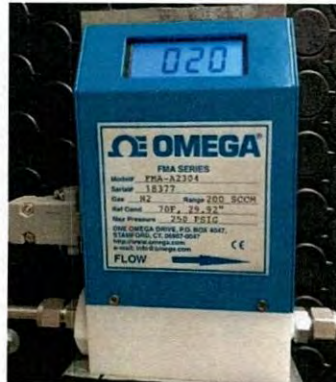
Figura 31. Controlador de flujo másico manual Omega modelo FMA-A2304 variable de 0 a 200 SCCM (centímetros cúbicos por minuto).
