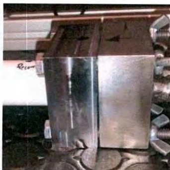
Figura 33. Imagen de las tapas para la prueba de vacío entre los bloques A1 y B1.
