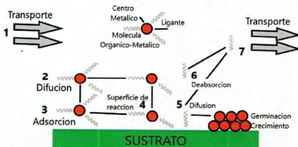
Figura 11. Diagrama básico del proceso MOCVD [47]
