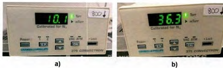
Figura 36. Lectura del sensor granville-phillips 375, (a) nitrógeno y (b) oxígeno.
