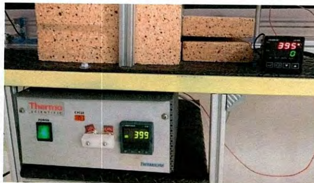
Figura 35. Imagen de la comparación de temperaturas entre los controladores eurotherm 2119 y omega CN7800.
