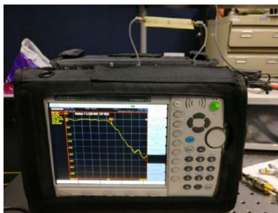
Figura 3.9: Analizador de redes vectoriales Anritsu® MS2038C utilizado en la caracterización de los LPFs microcinta.
