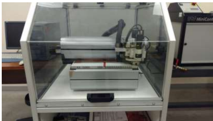
Figura 3.7: Máquina de prototipado para PCB, LPKF® ProtoMat H100 utilizada en la fabricación de los LPFs microcinta.
