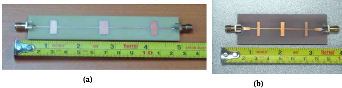
Figura 3.8: Filtros pasa baja microcinta con estructura de escalera LC de impedancia escalonada a) con f_c = 1 GHz (LPF-1) y b) f_c = 2 GHz (LPF-2), fabricados con una LPKF ProtoMat H100.
