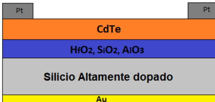
**Figura 31.** Estructura formada con contactos de Platino (superior) y Au (inferior)
