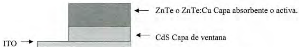
Figura 5.3.1.1 Estructura de CdS/ ZnTe:Cu sobre el sustrato ITO.
