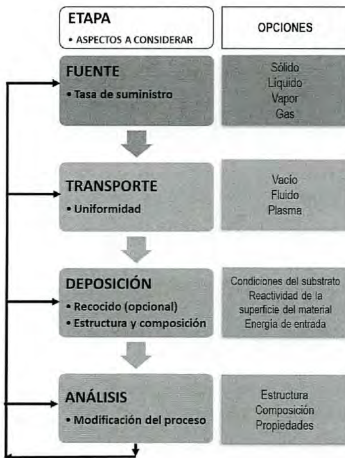
Figura 2.3.1 Proceso de fabricación y caracterización de películas delgadas.
