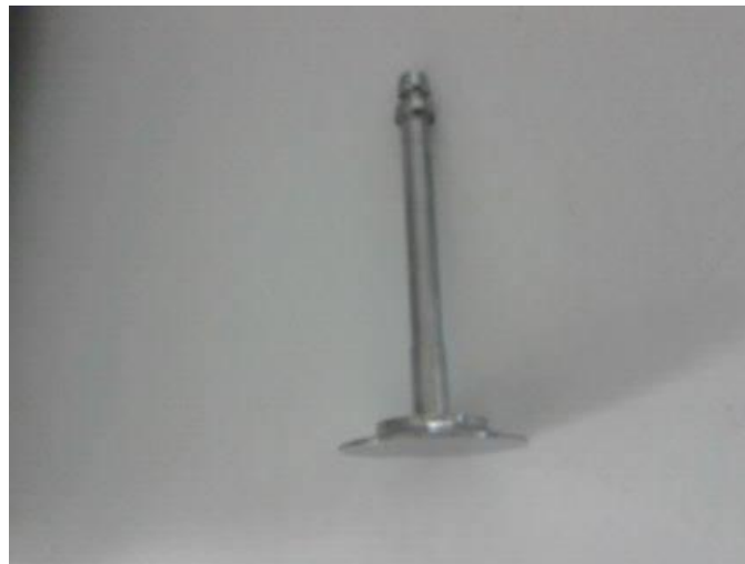
Figura 3. 4 Geometría Utilizada en el Reómetro para realizar las mediciones
