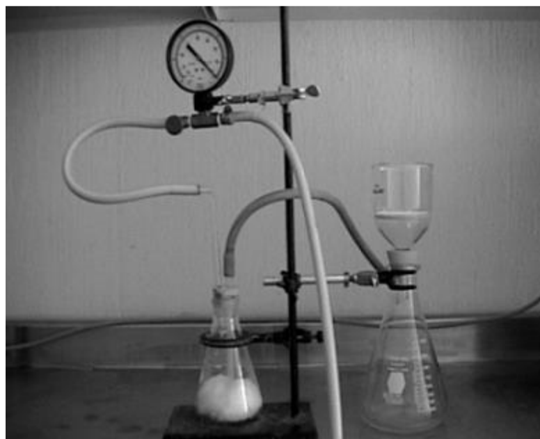
Fig. 3.2.2. Equipo de recuperación de muestra por filtración
