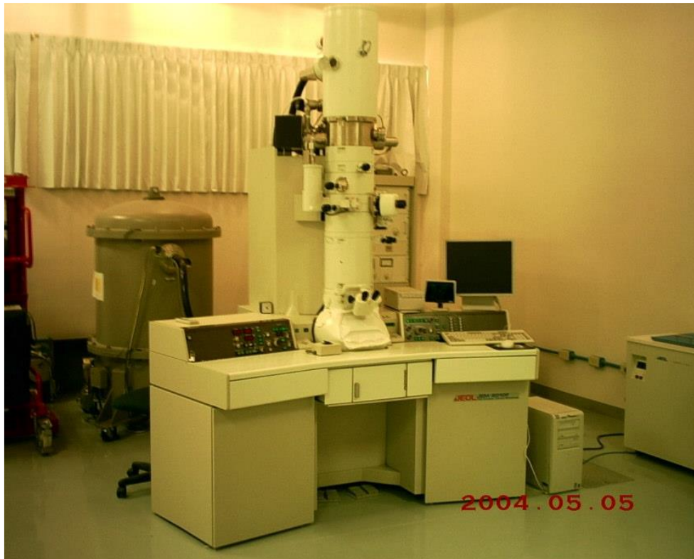
Fig.2.8.3. Microscopio Electrónico de Transmisión JEOL JEM2010F. Del Departamento de Física de la Universidad de Sonora
