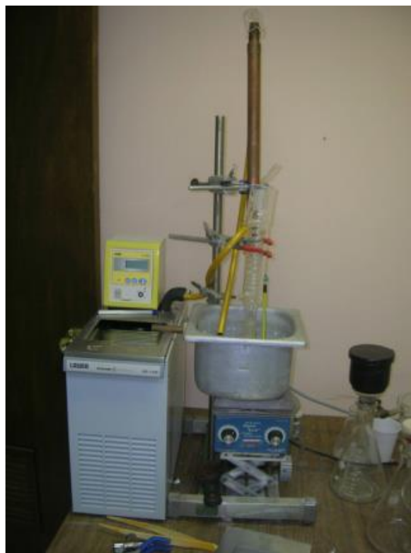
Fig. 3.2.1. Baño químico, filtro Buchner y matraz Kitazato
