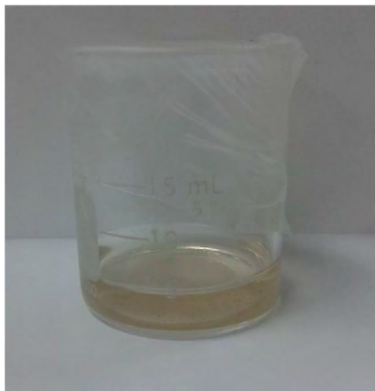
Figura 3.5: Fotografía del sistema de reacción para la síntesis de ZnS utilizando polietilenimina como agente acomplejante del zinc
