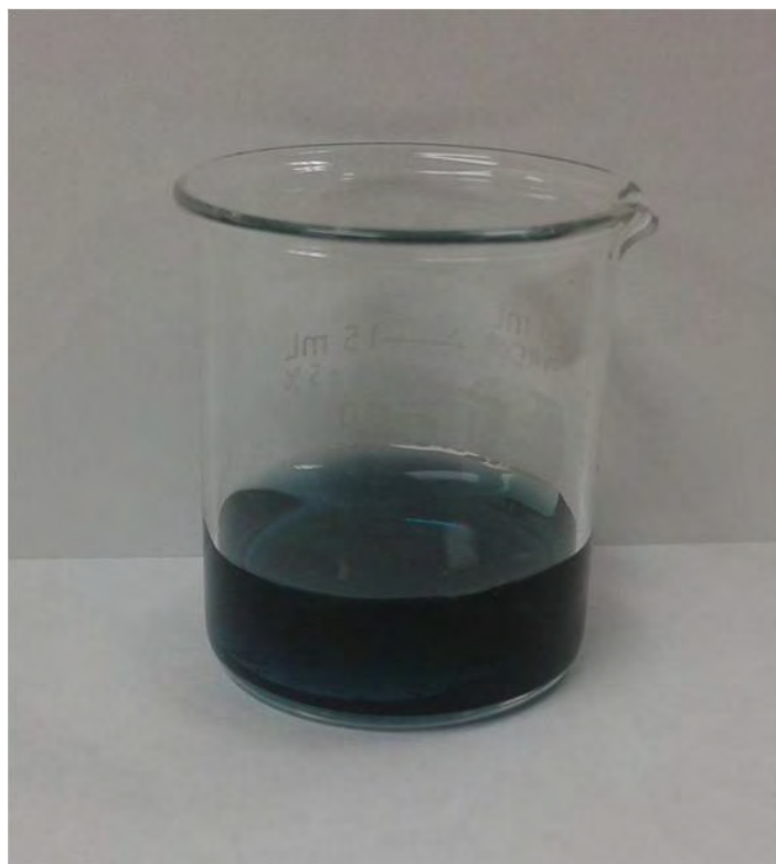
Figura 3.9: Fotografía de la muestra de \text{MoS}_2 utilizando agua oxigenada al 3% como agente acomplejante del Mo.
