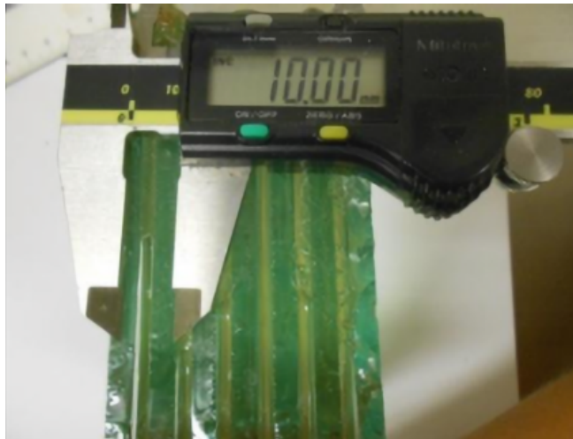
Figura 3.8: Multicapa de vidrio y cera-gel. Se muestra el calibrador digital como referencia de las dimensiones.
