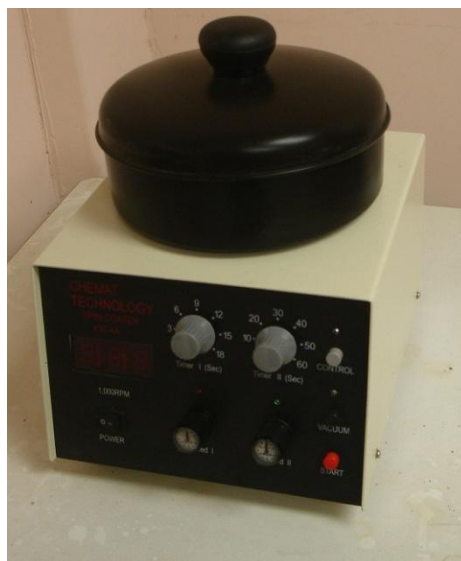
Figura 3.4. Fotografía del equipo de recubrimiento por rotación.
