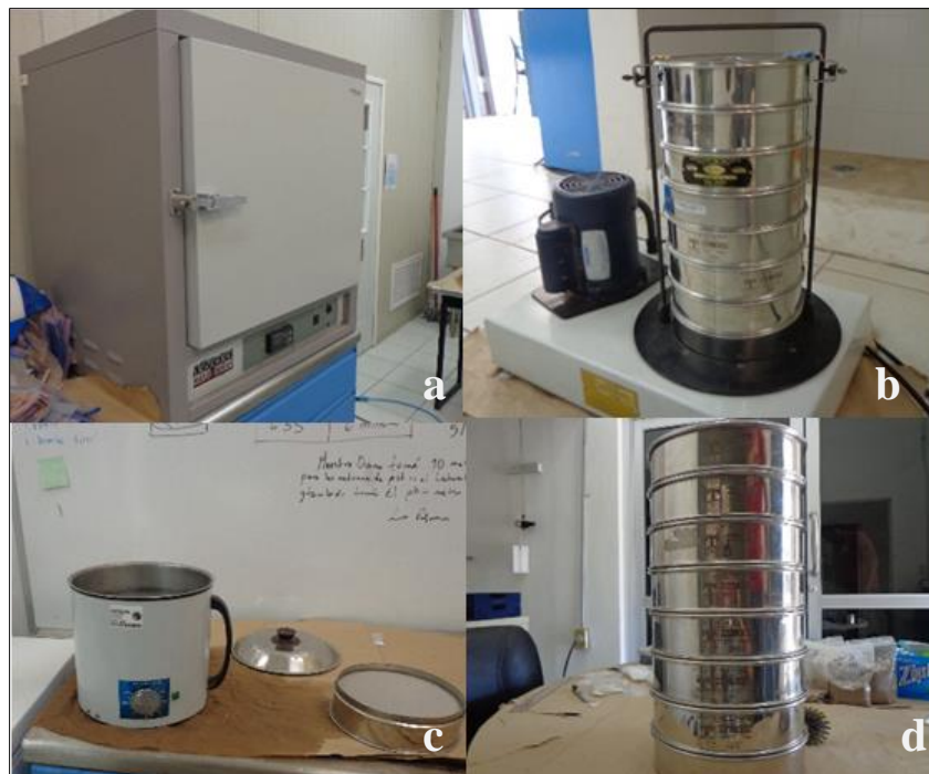
Figura 7. Instrumentos utilizados para la preparación de muestras, a) horno VWR 1600 HAFO Series, b) Ro-Tap 8 inch Tyler Ro-Tap Model RX-86, c) baño ultrasónico, d) tamices de acero inoxidable con mallas de 18 a < 635 .
