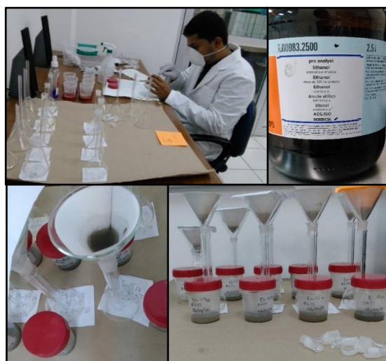
Figura 12. Tratamiento químico de lixiviación con etanol a las muestras seleccionadas
