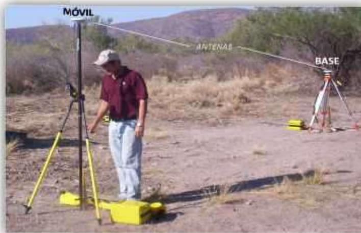
Figura 48 Equipo utilizado para nivelación de brocales.
