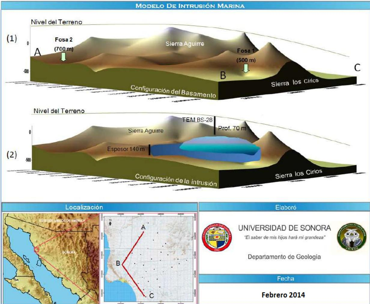
Figura 34 Configuración del basamento (1) y la intrusión salina (2), vista hacia el NE acuífero Puerto Libertad.
