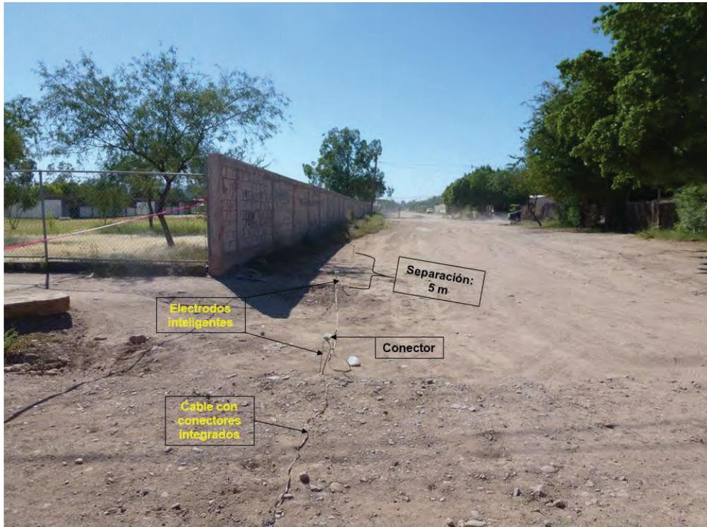
Figura 30. Perfil 3: Avenida Vicente Guerrero, con vista hacia el oeste, con una separación entre electrodos inteligentes de 5 m cada uno y una longitud de 250 m, aproximadamente.
