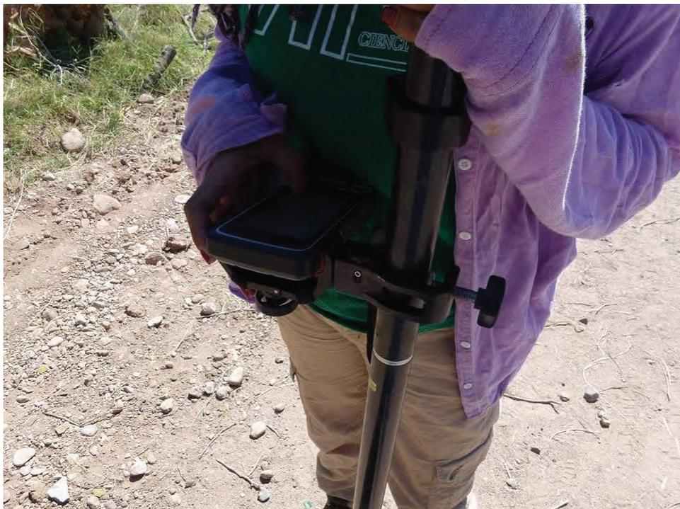
Figura 26. Equipo Colectora.
