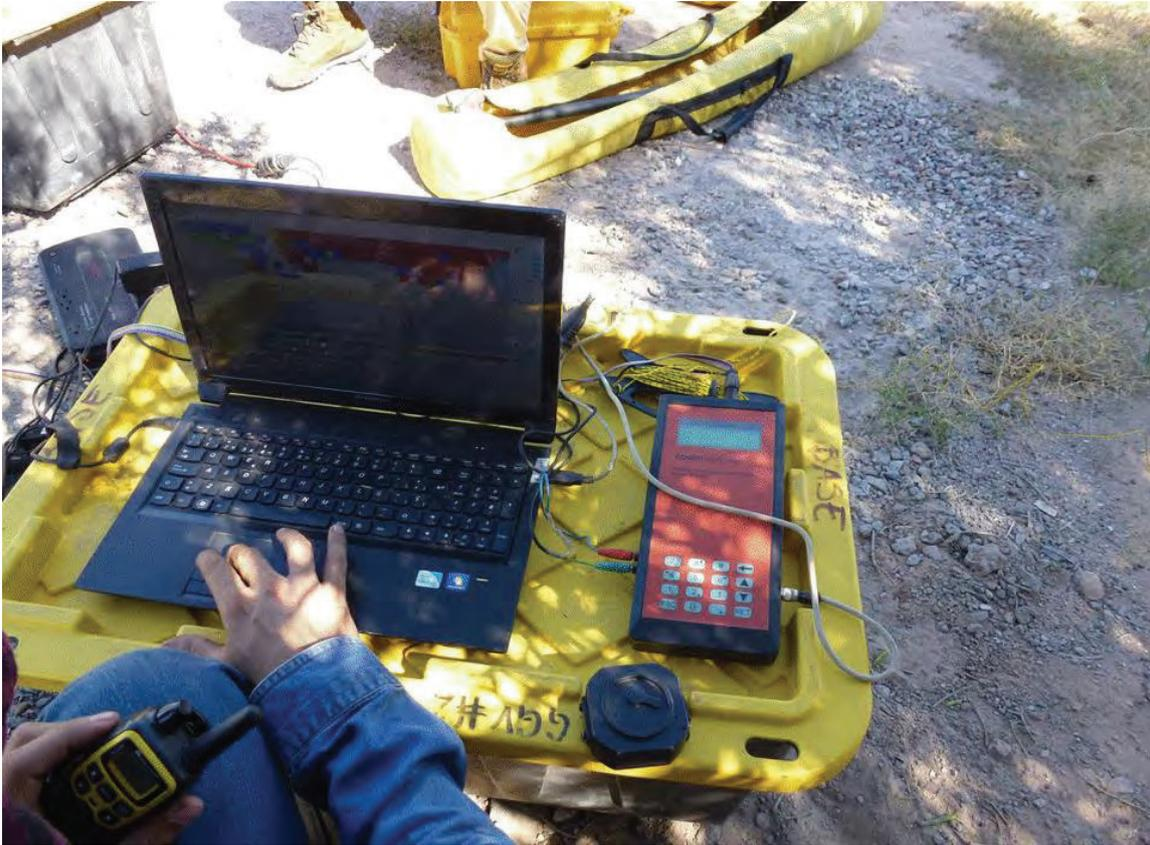
Figura 23. Equipo que se utilizó para el envío y recepción de energía eléctrica para la medición de los cambios de resistividad en el subsuelo: resistímetro (derecha) y laptop (izquierda).
