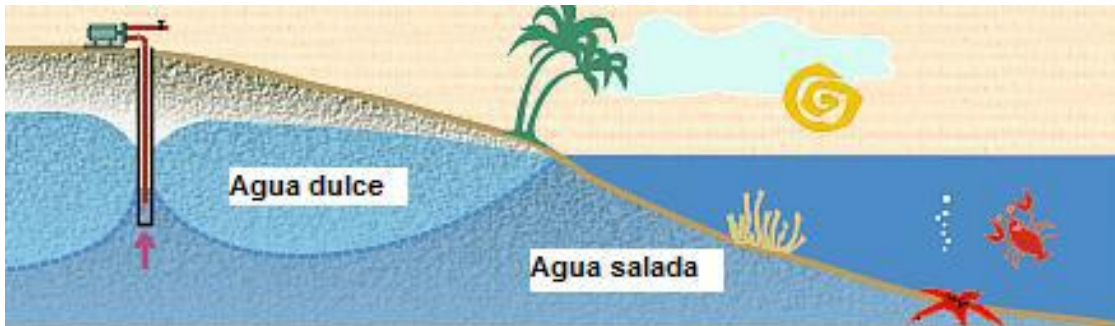
Figura 9.2 Cono de intrusión producido por bombeo puntual en una captación
