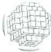
Figura 6.2: Esquema de la construcción de una nube esférica a partir de los elementos en los que se subdivide cada una de las celdas. Aquí podemos apreciar los 7 elementos en los que se subdivide la celda en cada dirección.
