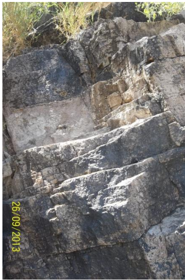
Foto 23 a) Unidad geotecnia Cerro Colorado, b) estructura bien trabada y selladas con relleno duro.
