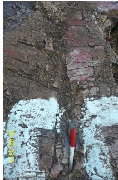
Foto 23 a) Unidad geotecnia Cerro Colorado, b) estructura bien trabada y selladas con relleno duro.
