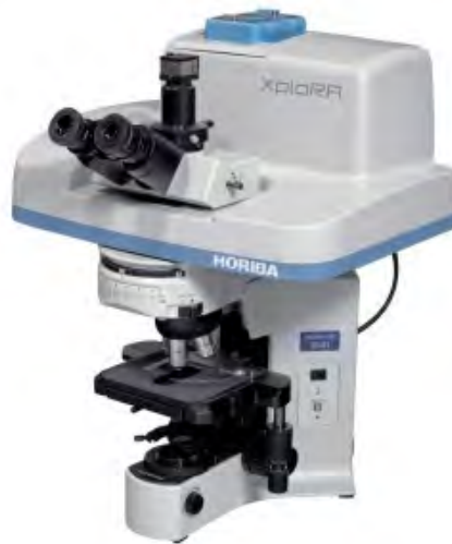
Fig.5.5.3 Espectroscopio MicroRaman Horiba Jobin Yvon, utilizado para la captura de los espectros RAMAN.
