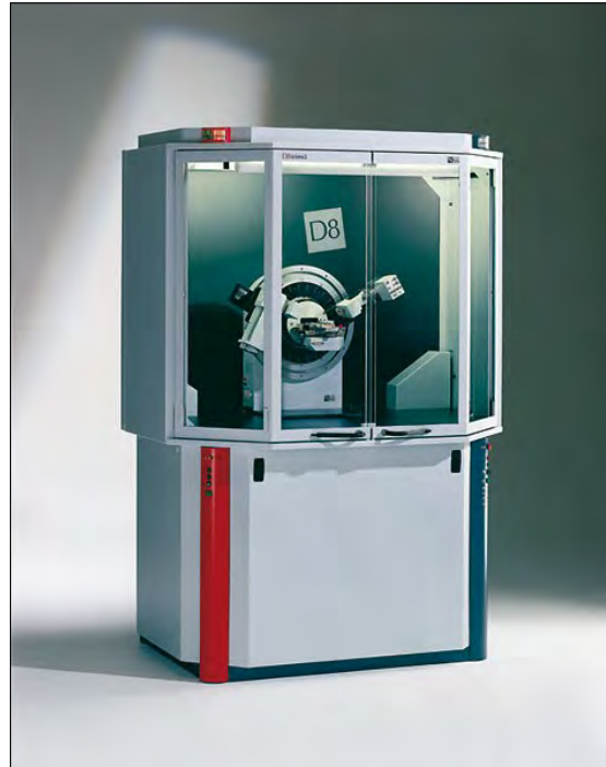
Fig. 5.3.1 Difractómetro de rayos X de polvos de la marca Bruker, modelo D8 Advance del Departamento de Geología de la Universidad de Sonora.
