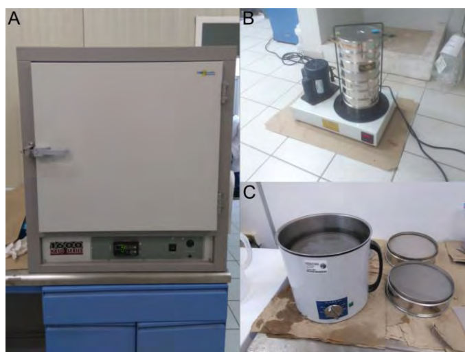
Figura 8. Equipo utilizado para la preparación de las muestras. A) Horno VWR 1600 HAFO Series. B) Agitador RoTap modelo RX-86. C) Baño ultrasónico.
