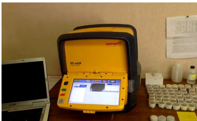
Figura 23. Equipo de Fluorescencia de rayos x, utilizado para la obtención de las concentraciones de metales.
