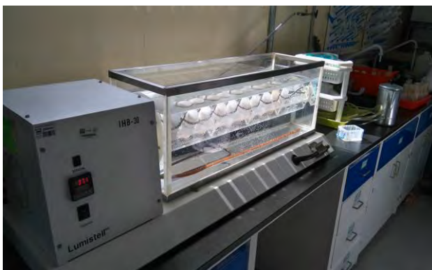
Figura 25. Equipo utilizado en realización de pruebas de bioaccesibilidad gástrica (NOM-147-SEMARNAT/SSA1-2004), localizado en el Laboratorio de Geoquímica Ambiental de la Universidad Autónoma de México.
