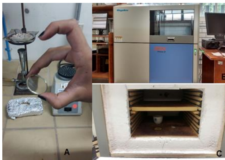
Figura 4.1 A) Perla de vidrio para análisis fluorescencia rayos X; B) Espectrometro de rayos X, Rigaku ZSX primus II. C) Horno para calcinar muestra y crisol de porcelana.
