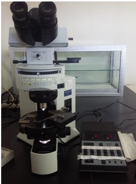
Figura 3.1 Microscopio Olympus BX-51 y contador Swift.
