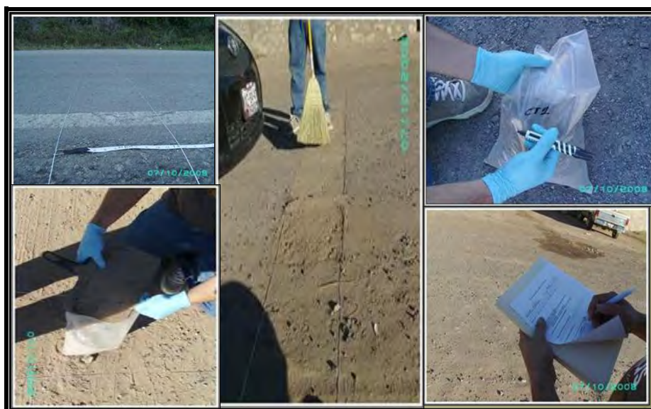
Fotografía 8.- Recolección de muestras en calles pavimentadas y no pavimentadas.
