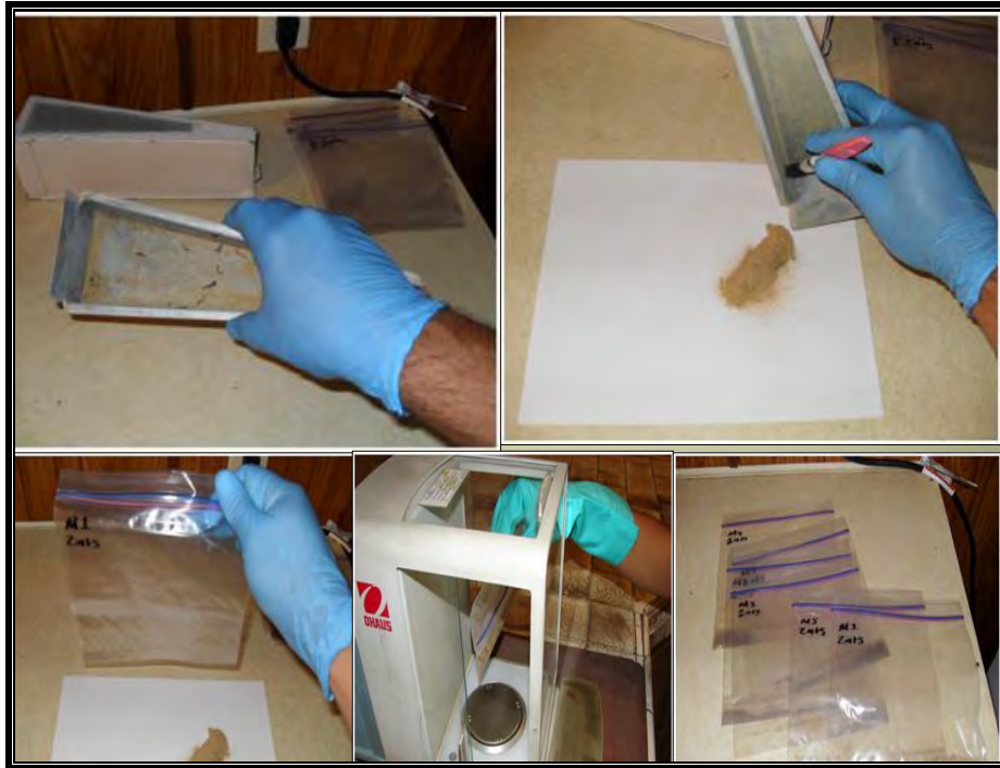
Fotografía 12.- Trabajo de laboratorio para las muestras recolectadas en los BSNE.
