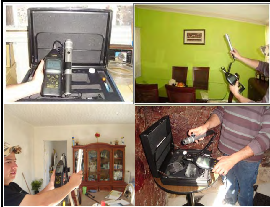
Fotografía 9.-Muestras realizadas con el aparato MicroDust en interior de vivienda.
