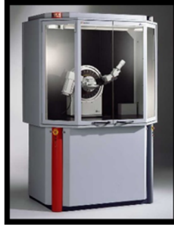
Figura 8.- Difractómetro de rayos X de polvos marca Bruker, modelo D8 Advance del Departamento de Geología de la Universidad de Sonora.
