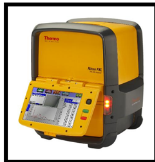
Figura 9.- Equipo de Fluorescencia de rayos X marca Microscopio electrónico de barrido marca Nitón FXL 950 del Departamento de Geología de la Universidad de Sonora.
