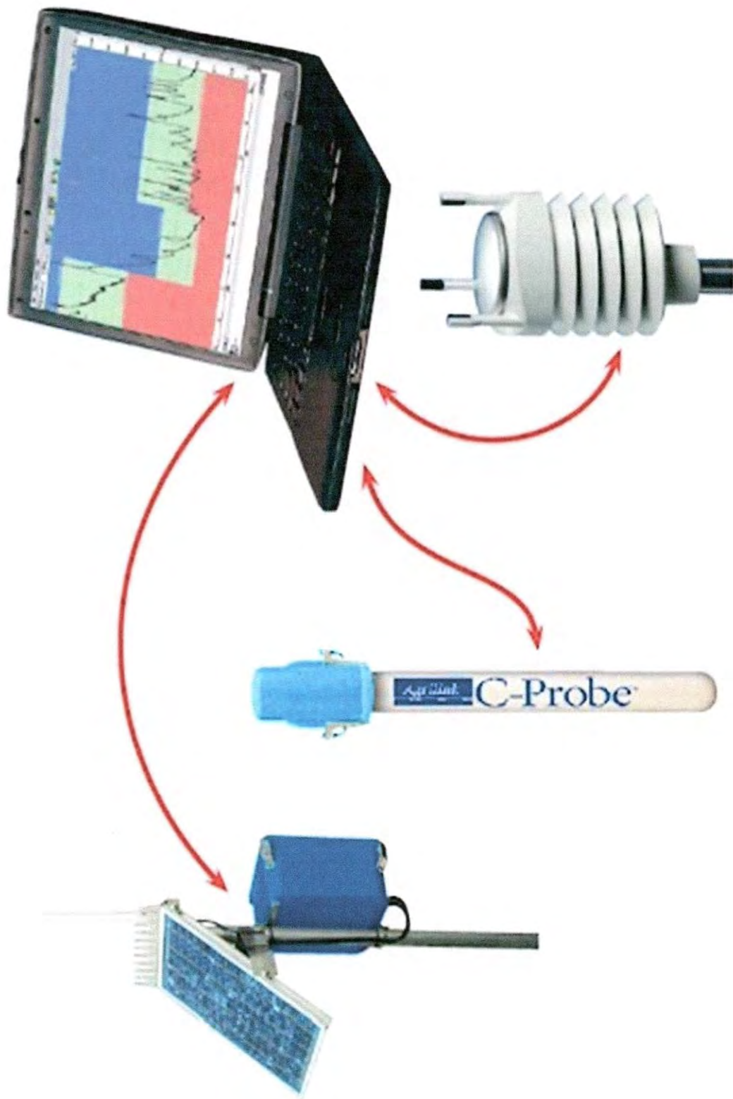
Figura 5. Sensor prueba de capacitancia (C-probe), dispositivo utilizado para medir el contenido volumétrico de agua en el suelo.
