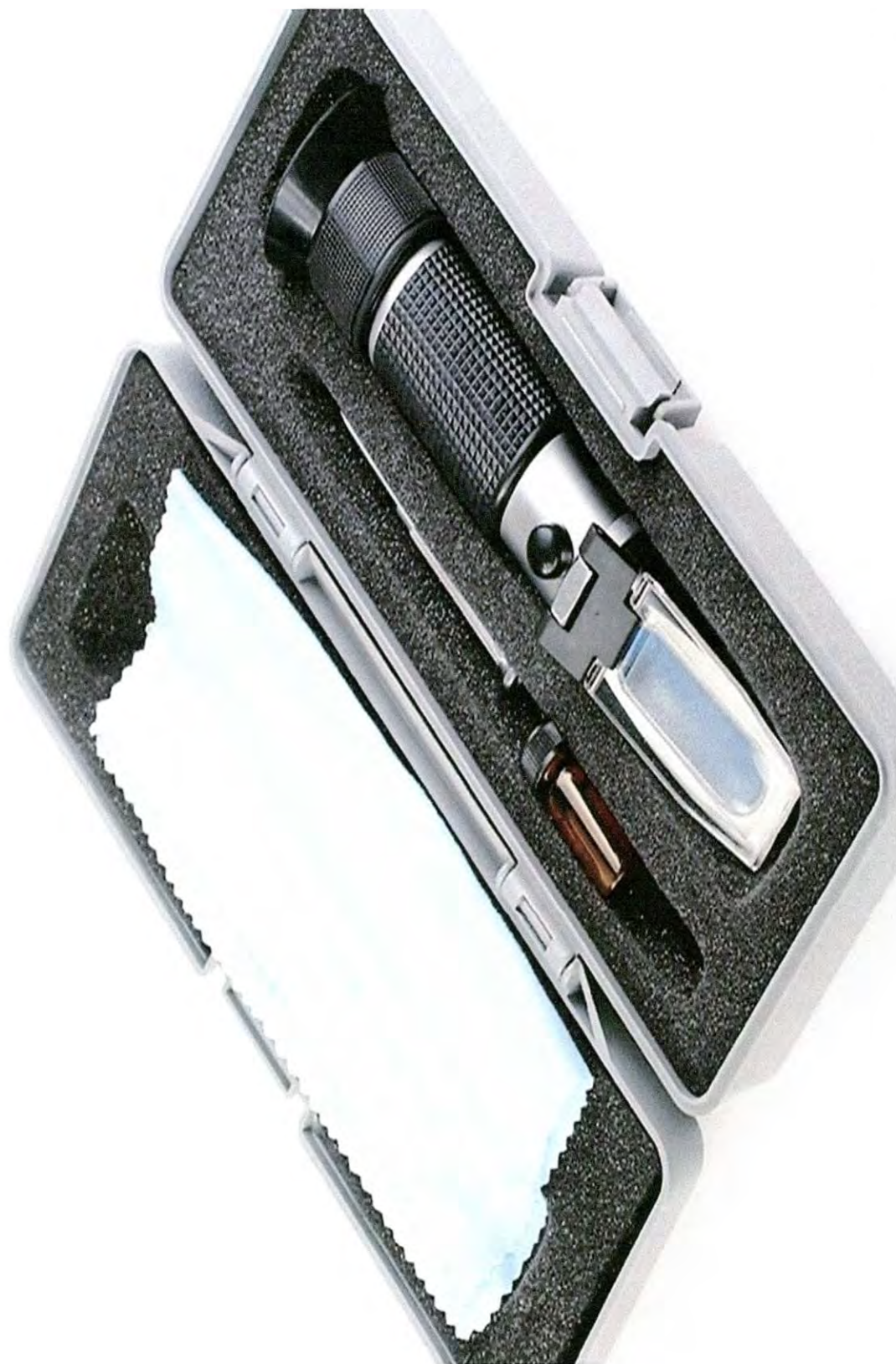
Figura 10. Refractómetro manual, dispositivo utilizado para medir la concentración de °brix en bayas de vid en el Viñedo "San Luis", Costa de Hermosillo, Sonora, México.
