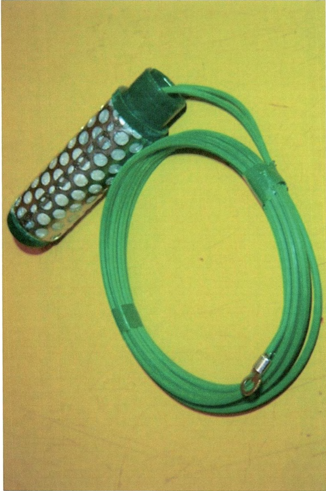
Figura 2. Sensor de resistencia eléctrica, dispositivo utilizado para medir la tensión (presión osmótica) de la humedad en el suelo.
