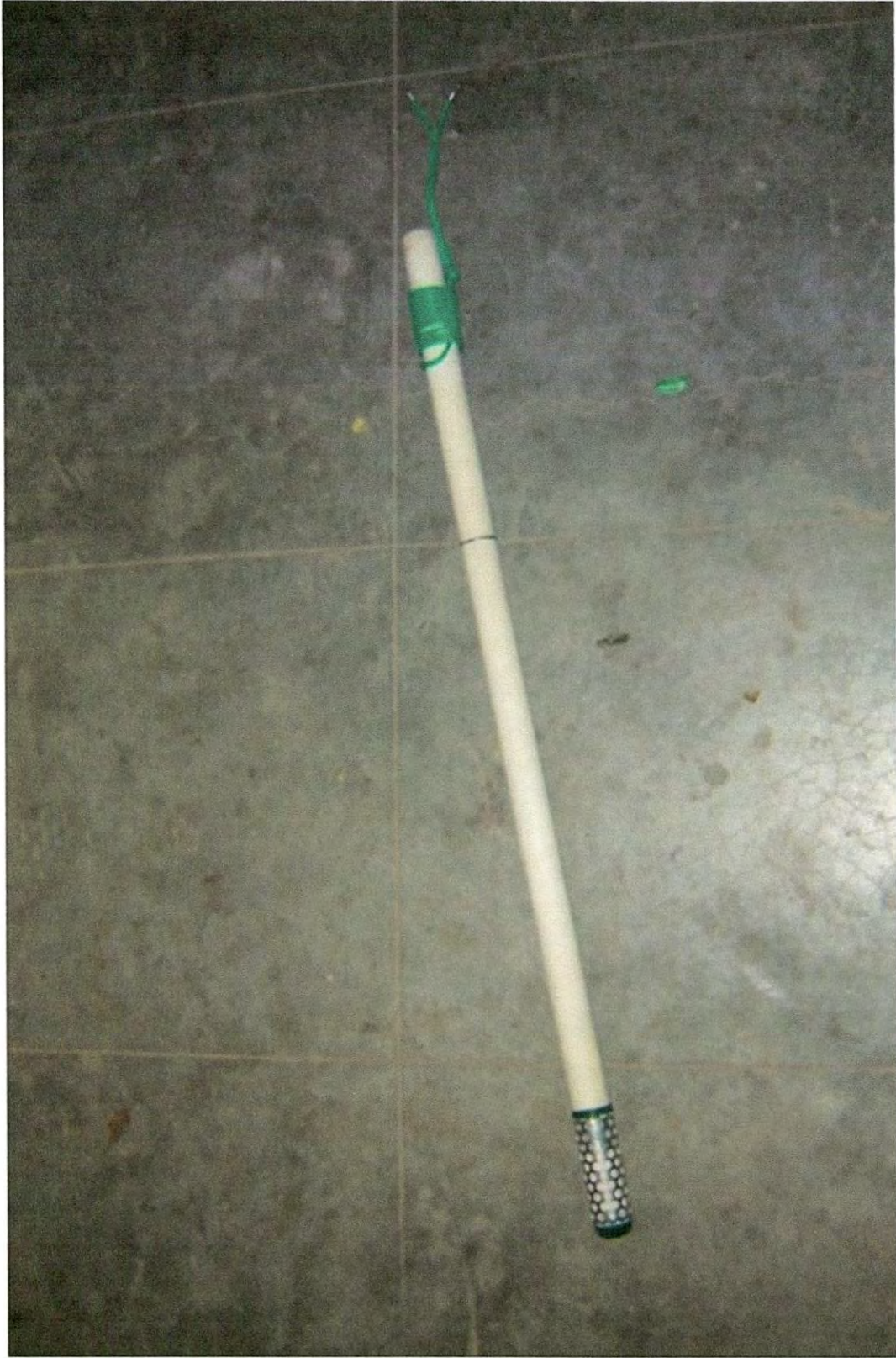
Figura 11. Sensor de resistencia eléctrica montado en un tubo de PVC, utilizado para medir la humedad del suelo en el Viñedo "San Luis", Costa de Hermosillo, Sonora, México.
