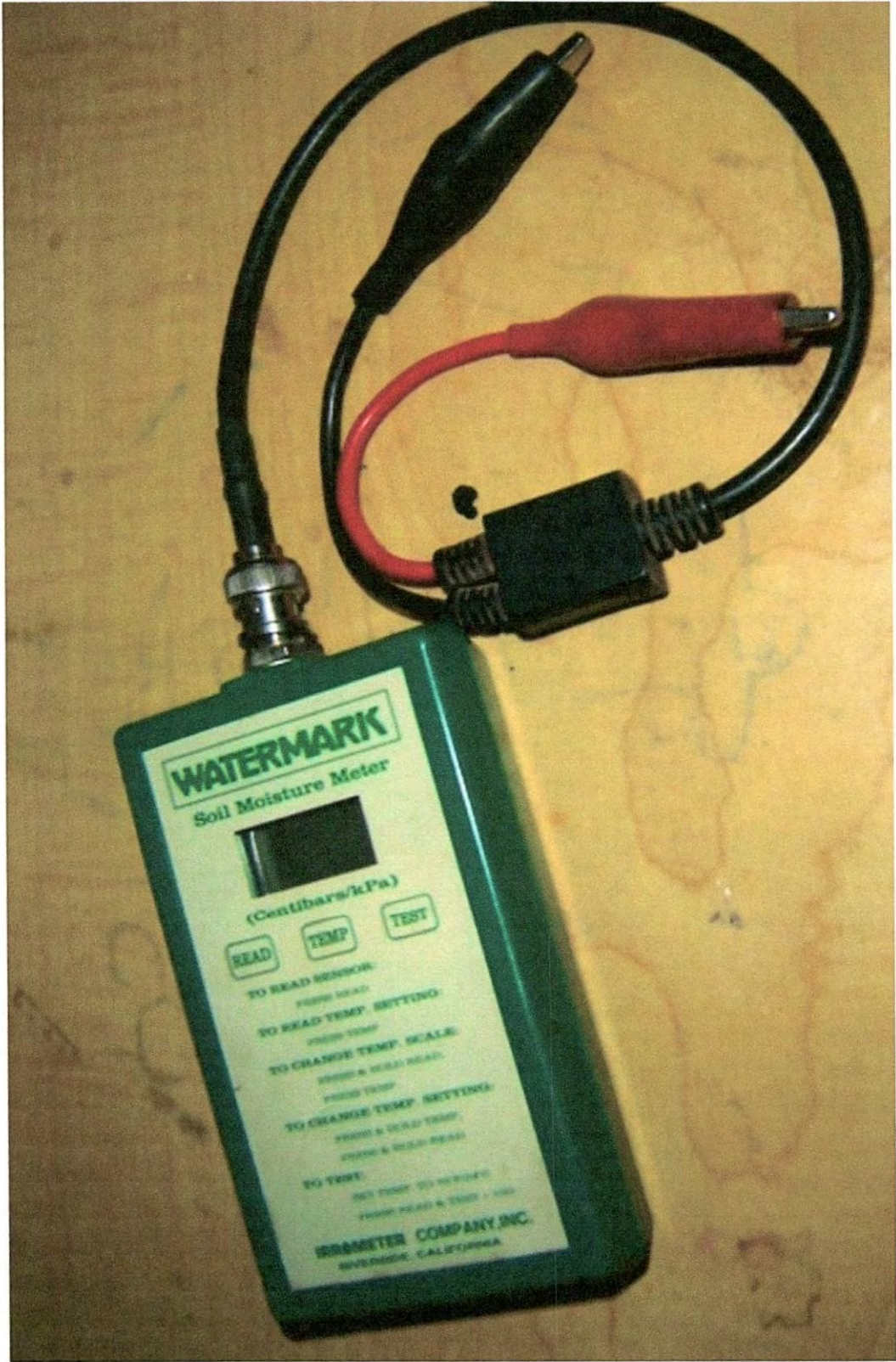
Figura 13. Medidor digital, instrumento utilizado para la toma de lecturas de resistencia eléctrica en el Viñedo "San Luis", Costa de Hermosillo, Sonora, México.
