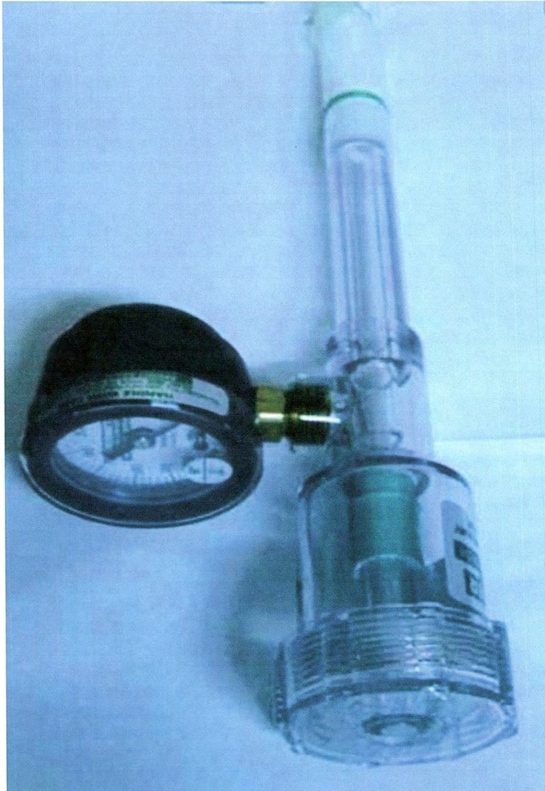
Figura 1. Tensiómetro, dispositivo usado para medir la tensión (presión osmótica) de la humedad en el suelo.
