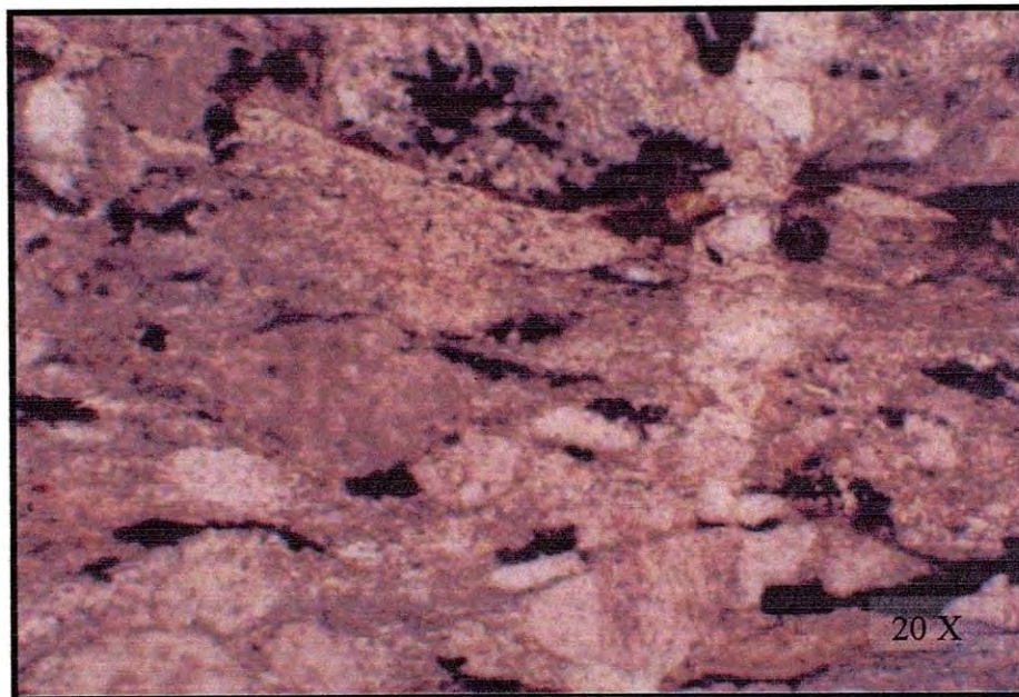
Imagen 2. Microfotografía en luz natural de gneiss granítico constituido por cristales de cuarzo-feldespato deformados; nótese la vetilla de cuarzo-clorita-epidota que corta a la roca, indicando evento hidrotermal posterior a la deformación.
