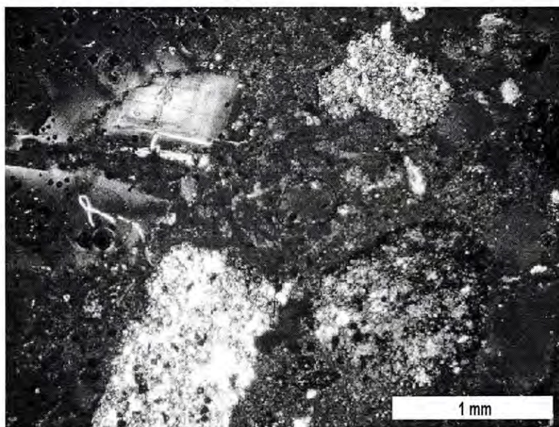
Foto 16.- Brecha tobácea o piroclástica con textura piroclástica (SFP-97), compuesta por fragmentos angulosos de hasta 1 cm en tamaño, compuestos principalmente de vitrófidos, sostenidos dentro de una matriz vítrea con un alto contenido de astillas de vidrio y menor contenido de cristales de plagioclasa y cuarzo. 4X, LP.
