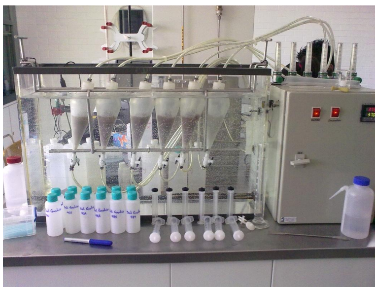
Figura 9. Imagen del equipo utilizado para la determinación de bioaccesibilidad gástrica e intestinal de metales establecido por Ruby et al. , 1993.
