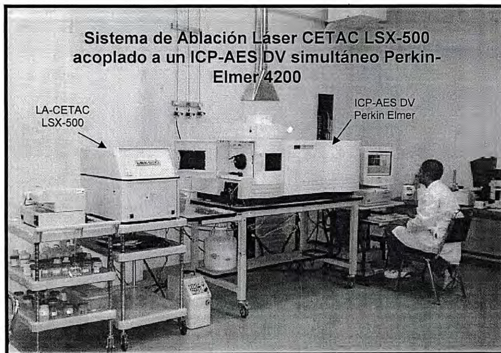
Figura 16. ICP-AES Optima 4200 Doble Vista Perkin-Elmer conectado a un sistema de ablación láser CETAC LSX-500 clase IV Nd:YAG, 266 nm.
