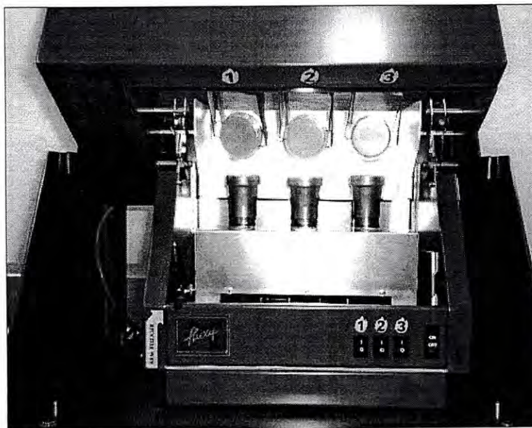
Figura 17. Hornillo Fluxy Claisse equipado con quemadores Fisher y moldes para la preparación simultanea de 3 perlas simultáneas.
