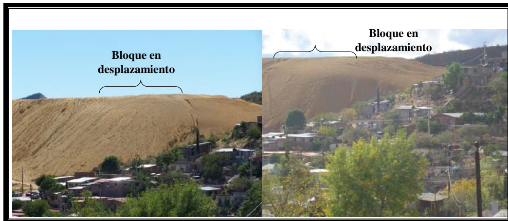
Fotografía 15.- La imagen de la izquierda nos muestra la vista del bloque en el mes de Noviembre del 2007, y la imagen de la derecha fue tomada en Diciembre del 2008, las imágenes muestran un cambio de pendiente significativo en el bloque.
