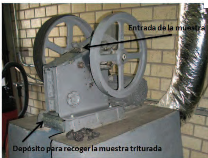
Figura 5.2: Quebradora Braun Chipmunk utilizada para procesar las muestras, ubicada en el Instituto de Geología de la ERNO.
