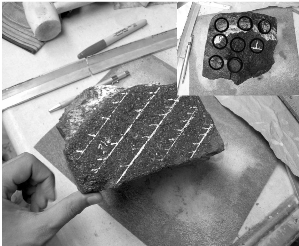
Figura 16.- Bloque de roca orientado con líneas de rumbo y perforaciones hechas en laboratorio.
