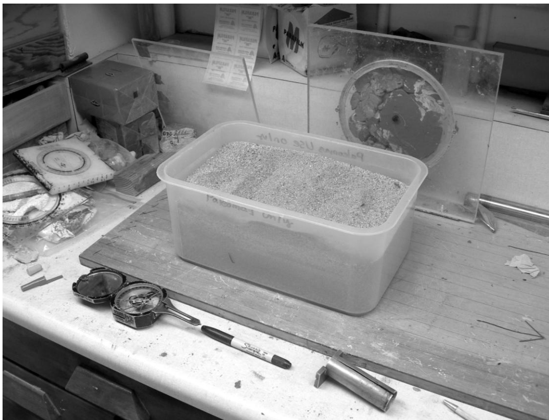
Figura 15.- Caja de arena, brújula y utensilios para la orientación de bloques.
