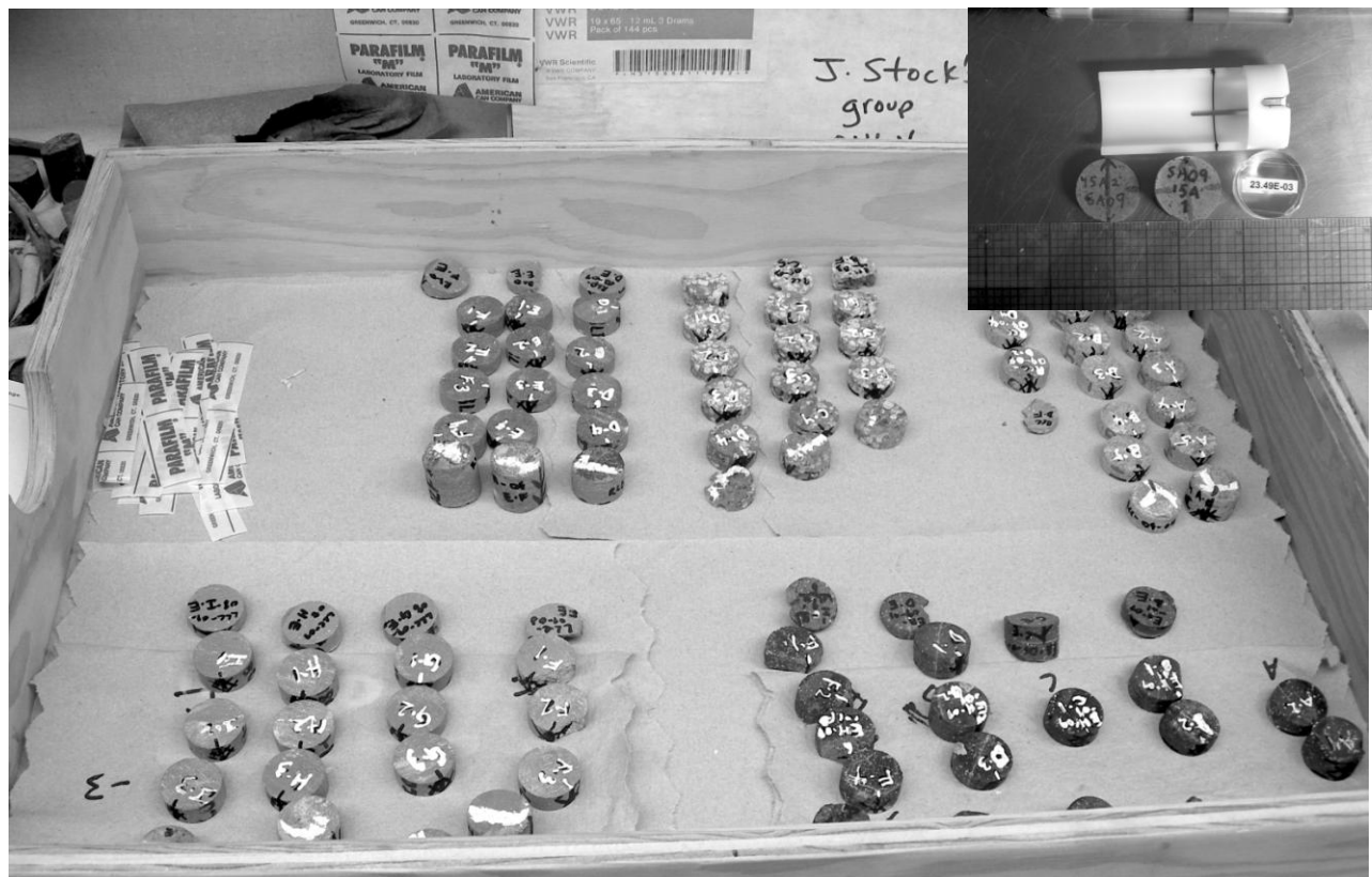
Figura 17.- Especímenes de cilindros de roca cortados y listos para las pruebas paleomagnéticas.
