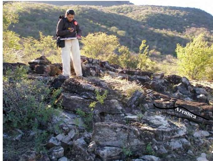
Figura 22. Foto tomada cerca de la obra El Pilar, caliza masiva de plataforma con horizontes de areniscas, presentan un rumbo NW60°SE con una inclinación casi horizontal.
