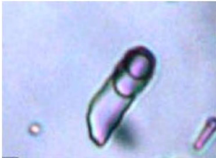
Figura 40. Muestra 04-20 inclusión fluida trifásica acuo-carbonosa  $\text{H}_2\text{O}-\text{CO}_2$ , Pérez-Segura (2006).
