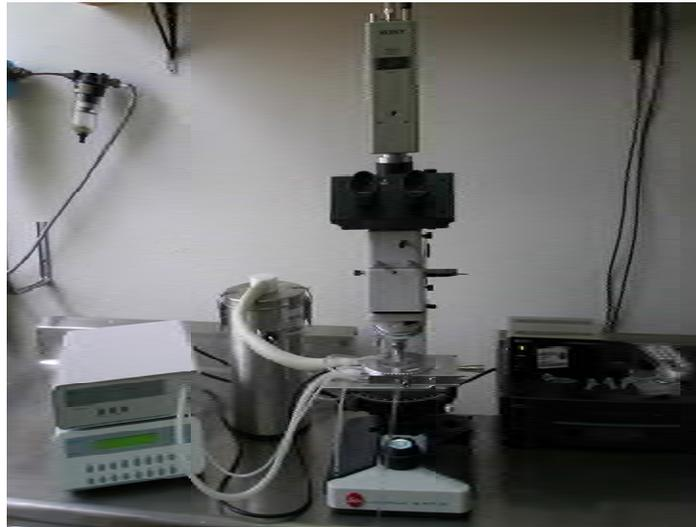
Figura 39. Platina Linkam modelo TMS 94 instalada al microscopio Leitz, foto tomada en el laboratorio de petrografía del Departamento de Geología, UNISON.
