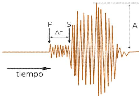
Como se muestra en esta reproducción de un sismograma, las ondas P se registran antes que las ondas S, el tiempo transcurrido entre ambos instantes es  $\Delta t$ ; este valor y el de la amplitud máxima ( $A$ ) de las ondas S, le permitieron a Richter calcular la magnitud de un terremoto.
