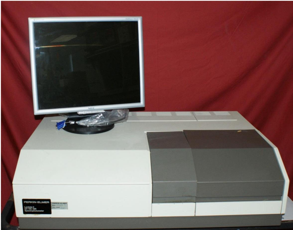
**Figura 25. Espectrofotómetro  $\lambda 19$  marca Perkin Elmer, utilizado en mediciones de absorción óptica.**
