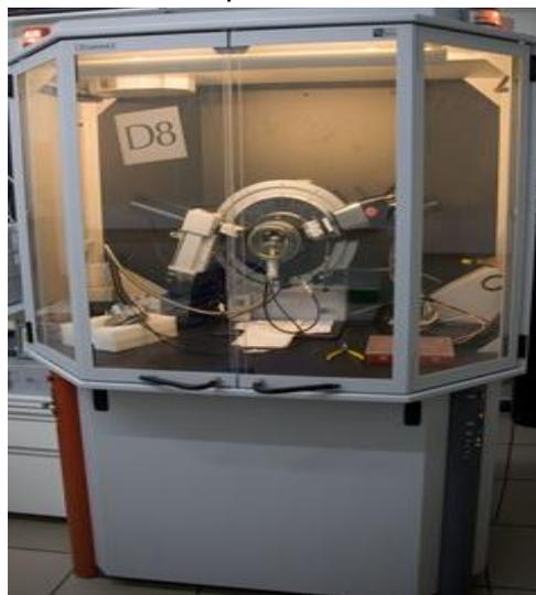
**Figura 13. Difractómetro de rayos X usado para analiza las muestras Modelo Bruker D8 ADVANCE.**
