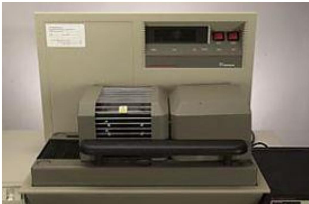
**Figura 19. Equipo de Análisis Térmico TA Instrument SDT2960.**
