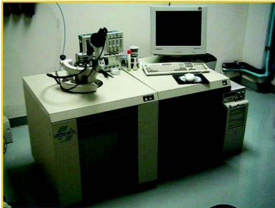
Figura 16. AFM marca JEOL, modelo JSPM 4210
