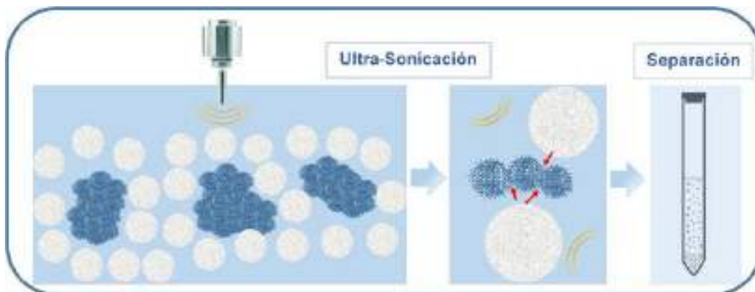
Figura 3.1 Representación esquemática del proceso empleado para la desaglomeración. Los nanodiamantes de detonación y las perlas de sílica son ultrasonificados juntos y luego separados por centrifugación.
