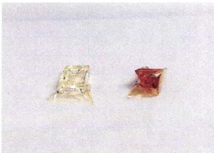
**Figura 37** Matrices de SiO<sub>2</sub> sintetizadas con HCl (izquierda) y HNO<sub>3</sub> (derecha)
